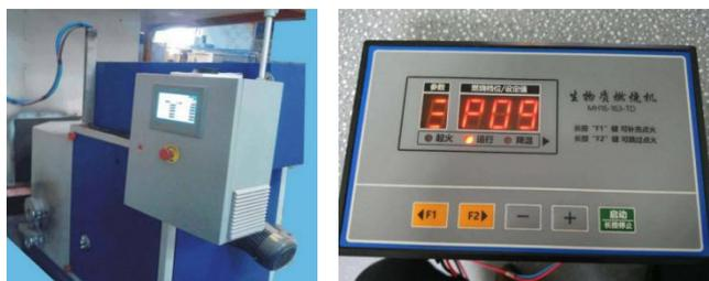
(a) 研发的生物质燃烧机智能控制系统
