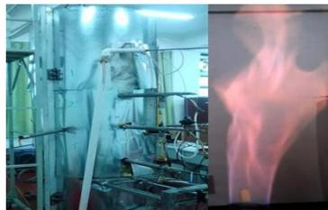
图 2 下吸分流式固定床秸秆气化炉实验装置（左图）
