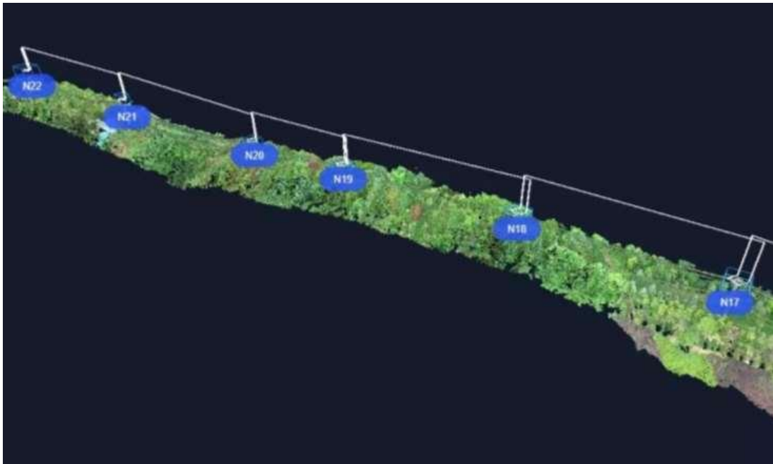
图 4-5 电力巡检无人机场景布置及航线规划示意图
