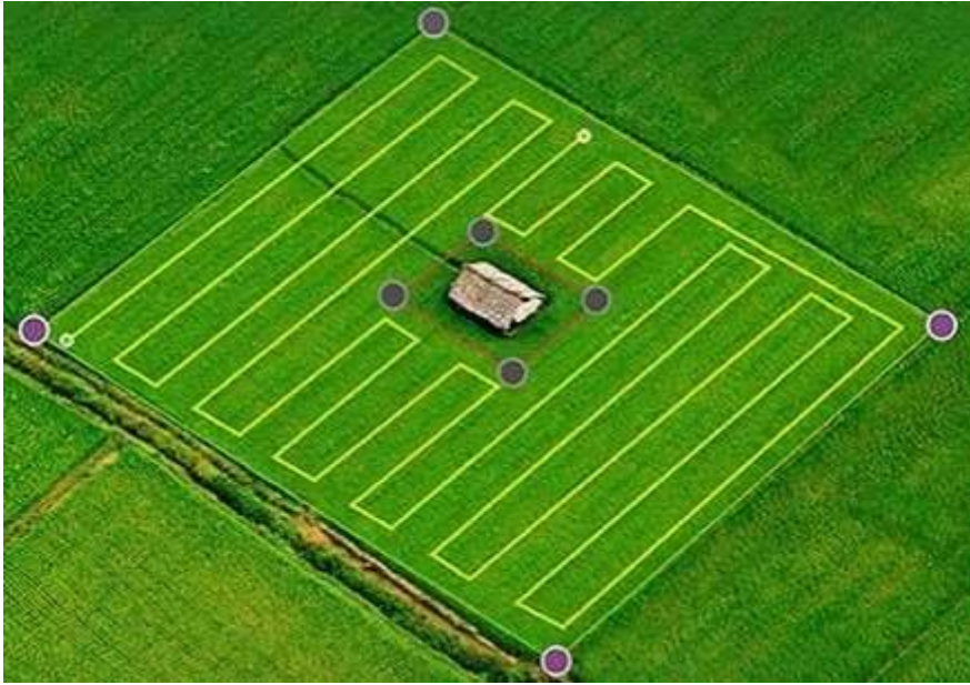
图 4-4 农业植保无人机场景布置及航线规划示意图
